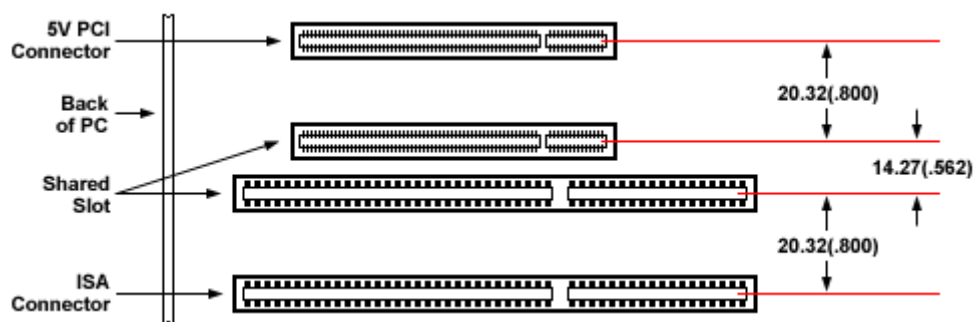
Gambar IV-7. Ukuran slot ekspansi PCI dan ISA
